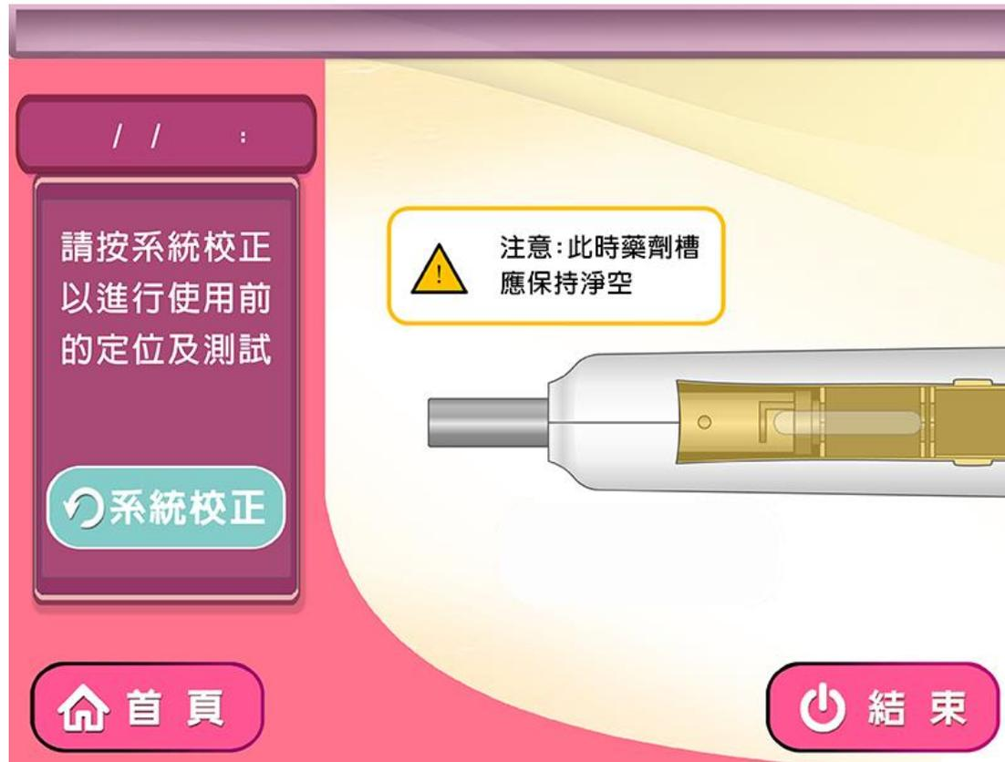
如定位過程中內裝有原先用過的針筒或異物阻擋，系統會跳出警示視窗，取下異物後再按一次「系統校正」。
