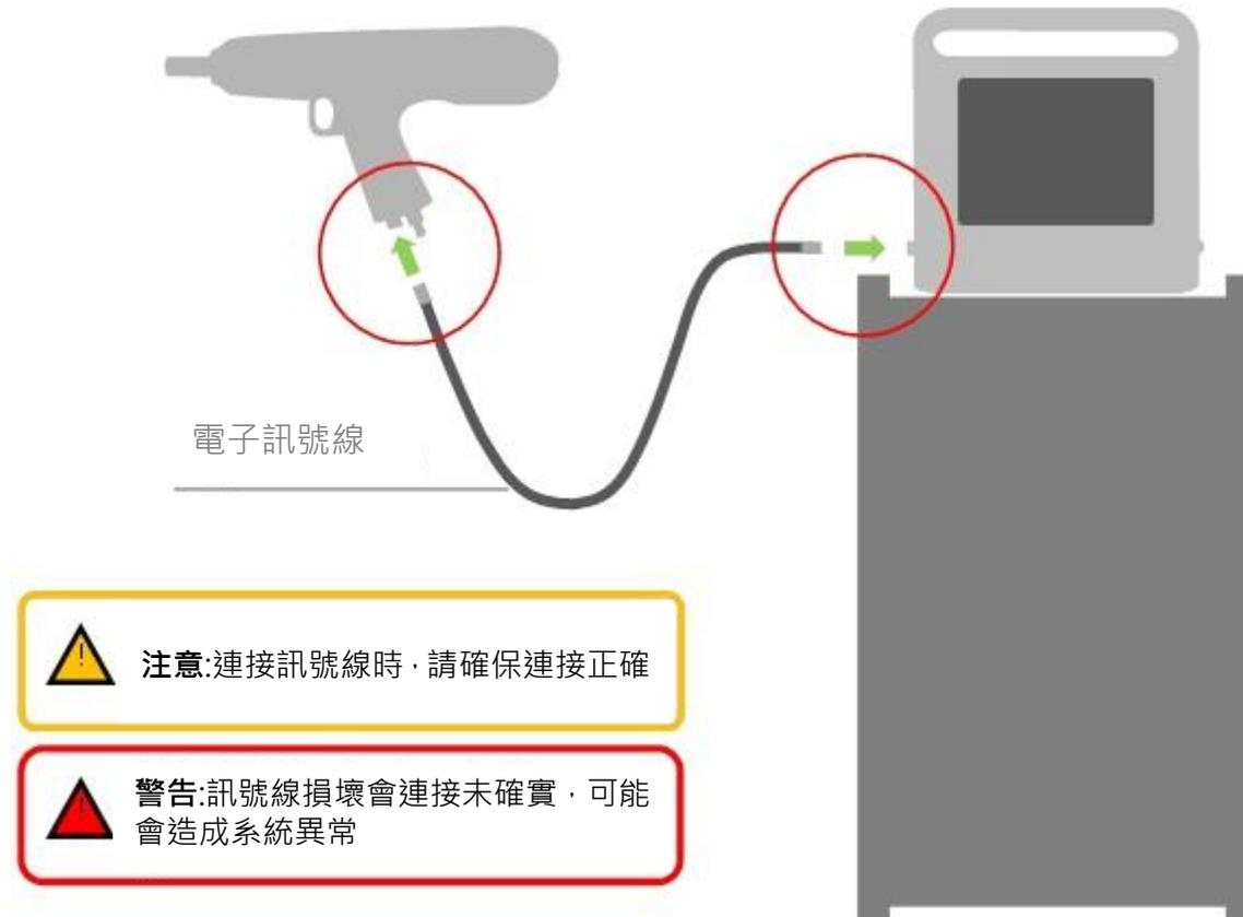
安裝電子訊號線時，先辨識主機上公接頭之"定位凸塊"及電子訊號線母接頭的"定位凹塊"，將兩者旋緊，選轉黑色環。
