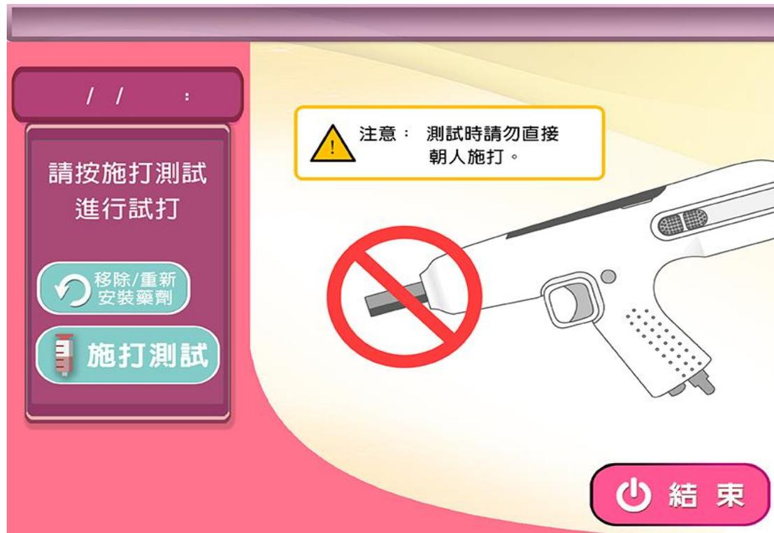
施打劑量以 0.02 cc 為最小單位，最大可選至 0.10 cc。選定施打劑量後按下「確定」，待 LED 指示燈亮起後，表示藥劑已填注完成，可將投遞口對準目標物進行施打，連續扣兩下板機為一次完整劑量施打。
