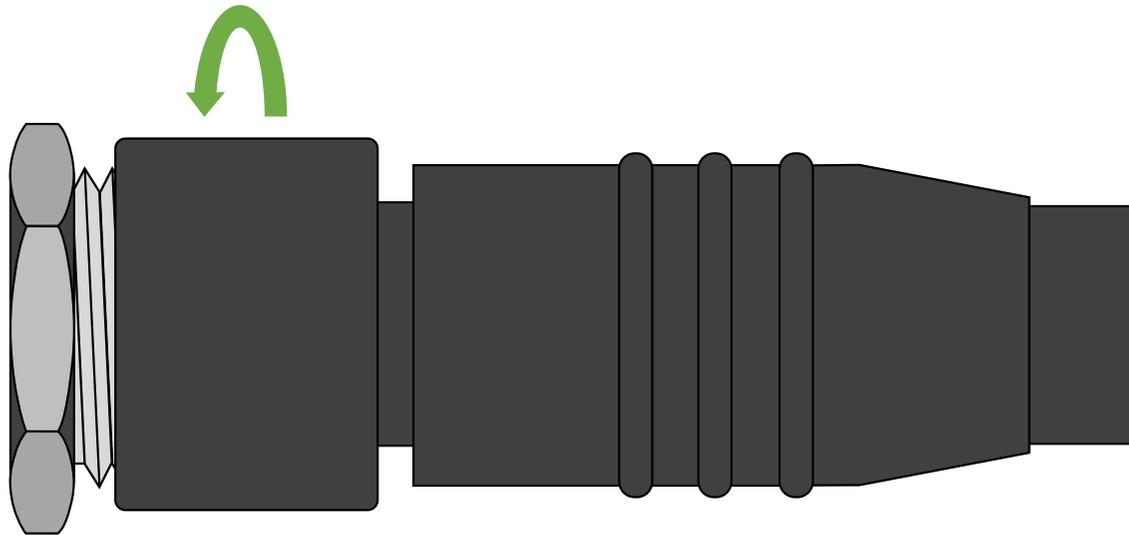
連接氣體連接管到氣體調壓閥及投遞器
